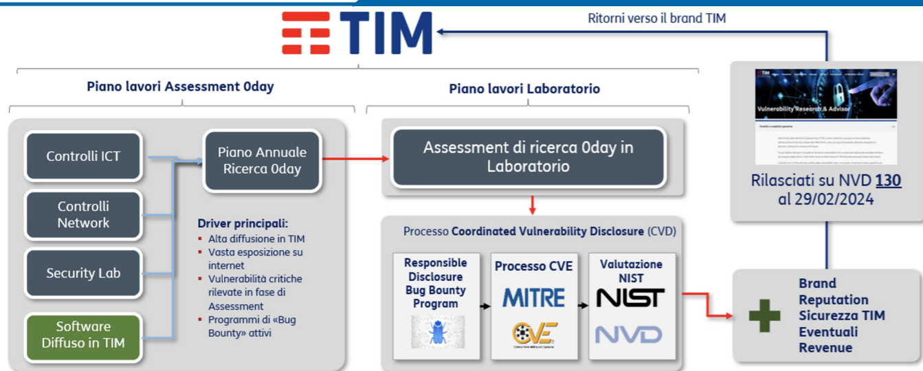
Figura 3: Processo di alimentazione della ricerca degli zeroday in TIM e Coordinated Vulnerability Disclosure
